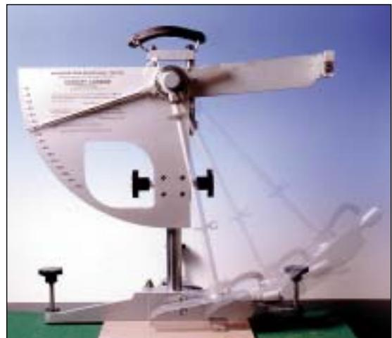
**Figure 1:** Wet pendulum test apparatus
